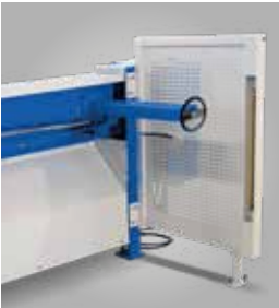
Rückraum durch Lichtschranke abgesichert
